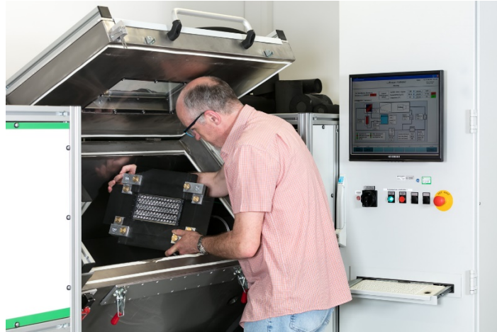
Abbildung 3: Einbau eines Heizregisters in den Luftkanal (Laborleiter: Hr. Schäffner)
